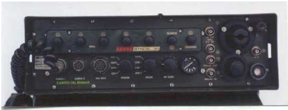
PANEL FRONTAL DEL EQUIPO DE RADIO RACAL SINCAL 30
